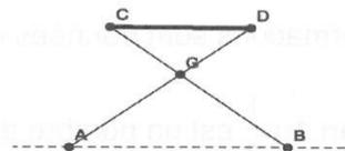
On a modélisé géométriquement un tabouret pliant par les segments [CB] et [AD] pour l'armure métallique et le segment [CD] pour l'assise en toile.
